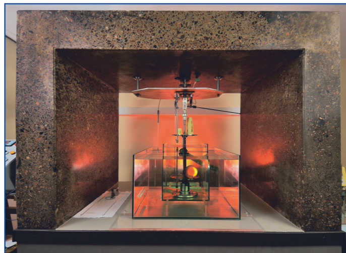
Эталонная установка ЭУ-1 из состава Государственного первичного эталона единицы плотности ГЭТ 18-2014
