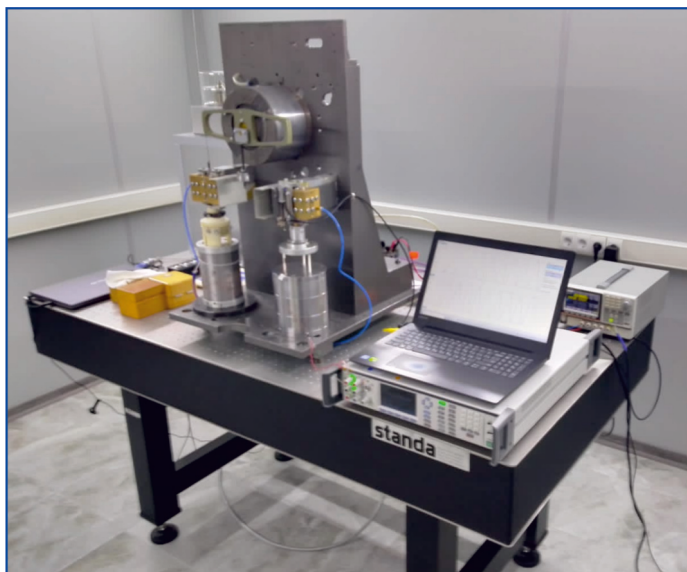
Рис. 1. Макет ватт-весов на основе равноплечной рычажной системы и аэростатической опоры
