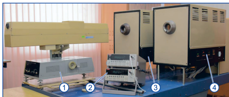
Рис. 2. Общий вид эталона: 1 – пирометр-компаратор; 2 – нановольтметр; 3 – АЧТ-излучатель переменных температур; 4 – АЧТ-излучатель на реперных точках
