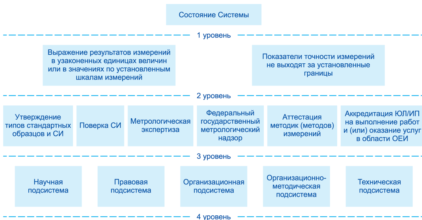
Рис. 1. Иерархическая модель оценки состояния системы обеспечения единства измерений (Системы): СИ – средства измерений; ЮЛ/ИП – юридические лица/индивидуальные предприниматели; ОЕИ – обеспечение единства измерений
