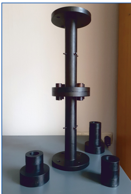
Рис. 1. Специальный эталон массы, координат центра масс и момента инерции
