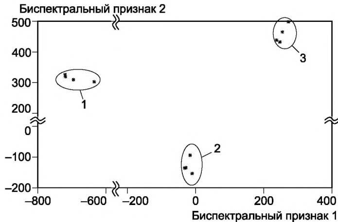
Рис. 3. Расположение в пространстве распознавания образов функций откликов для балки, ослабленной трещиной с различной глубиной залегания:
