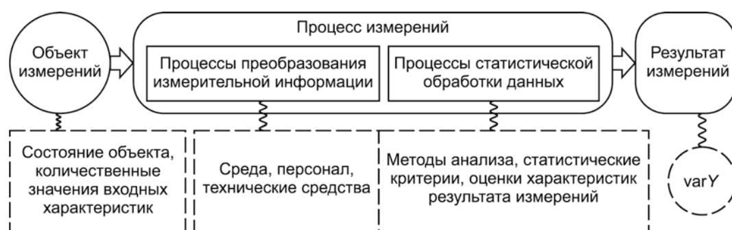
Рис. 2. Укрупнённая модель измерения как комплекса источников потенциальных факторов потерь робастности метода измерений 2-го рода
