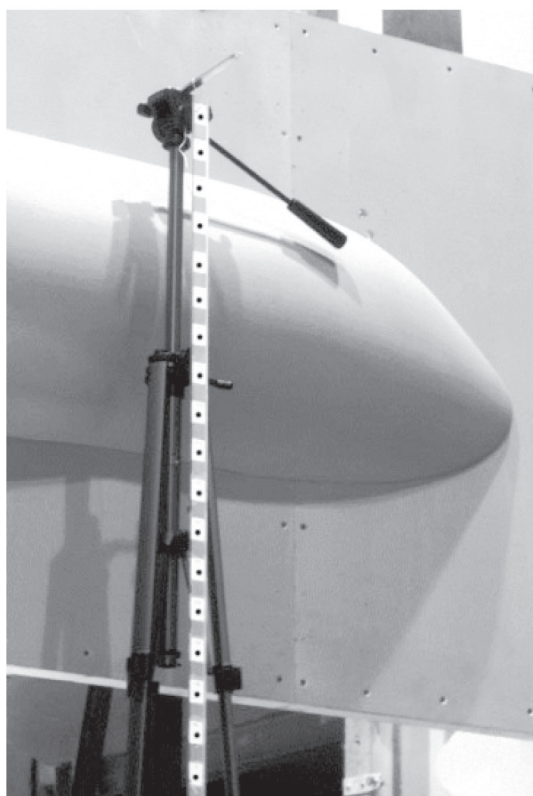
Рис. 1. Облегчённое контрольное приспособление типа тест-рейки и пример его применения при экспресс-калибровке:
