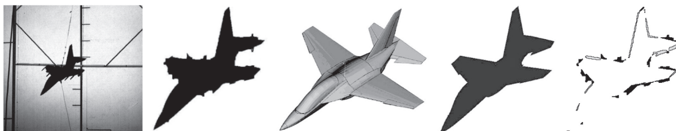
Рис. 4. Последовательность операций в методе видеограмметрии с конвергенцией изображений
