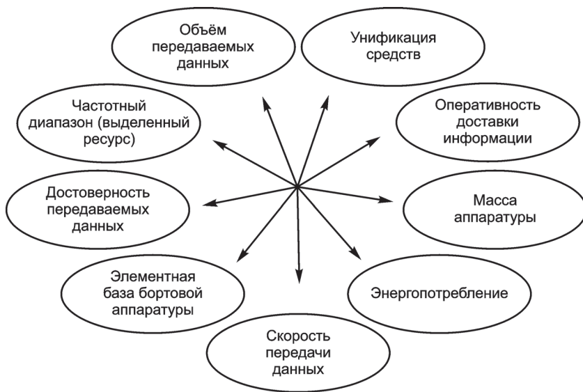
Рис. 1. Основные показатели и характеристики информационно-телеметрического обеспечения испытаний летательных аппаратов
