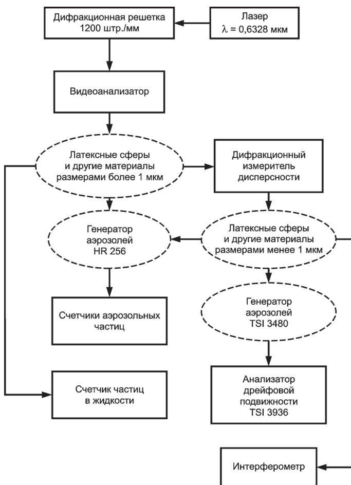
Рис. 3. Функциональная схема эталона ГЭТ 163—2010
