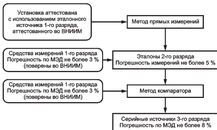
Рис. 3. Схема передачи единиц МЭД от эталонного источника 1-го разряда серийным источникам
