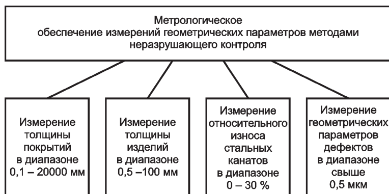
Рис. 1. Виды измерений геометрических параметров методами неразрушающего контроля
