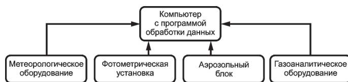
Рис. 1. Функциональная схема автоматизированной системы контроля качества воздуха
