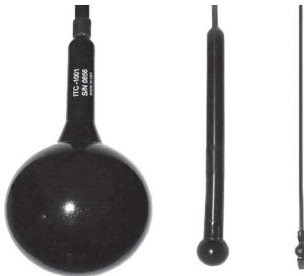
Рис. 1. Измерительные преобразователи установки Э-4 с активными элементами разных диаметров: 100; 20 и 5 мм
