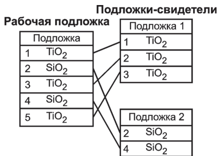
Рис. 2. Схема разбиения дизайна по двум контрольным подложкам при непрямом методе контроля напыления
