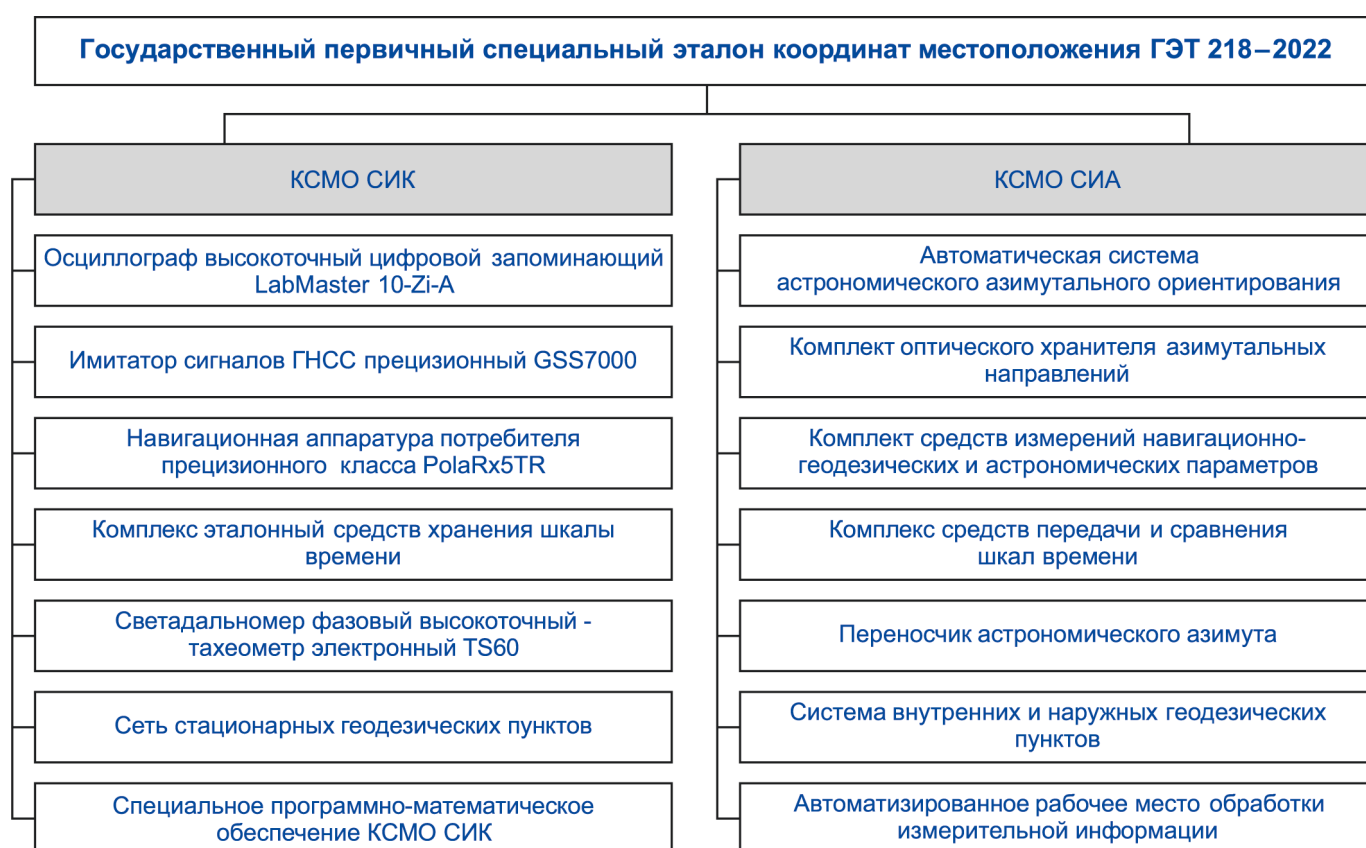
Рис. 1. Состав Государственного первичного специального эталона координат местоположения ГЭТ 218-2022: КСМО СИК – комплекс средств метрологического обеспечения средств измерений координат; КСМО СИА – комплекс средств метрологического обеспечения средств измерений азимута
