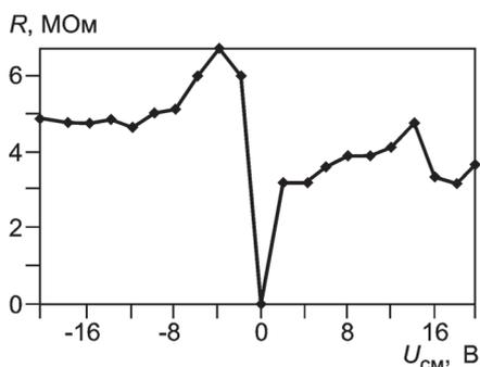
Рис. 6. Зависимость сопротивления изоляции  $R$  от  $U_{CM}$  при  $T_n = 850$  °C для термопары диаметром 3 мм
