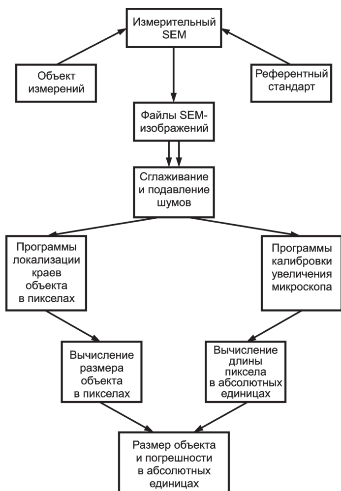
Рис. 1. Схема проведения измерений критических размеров
