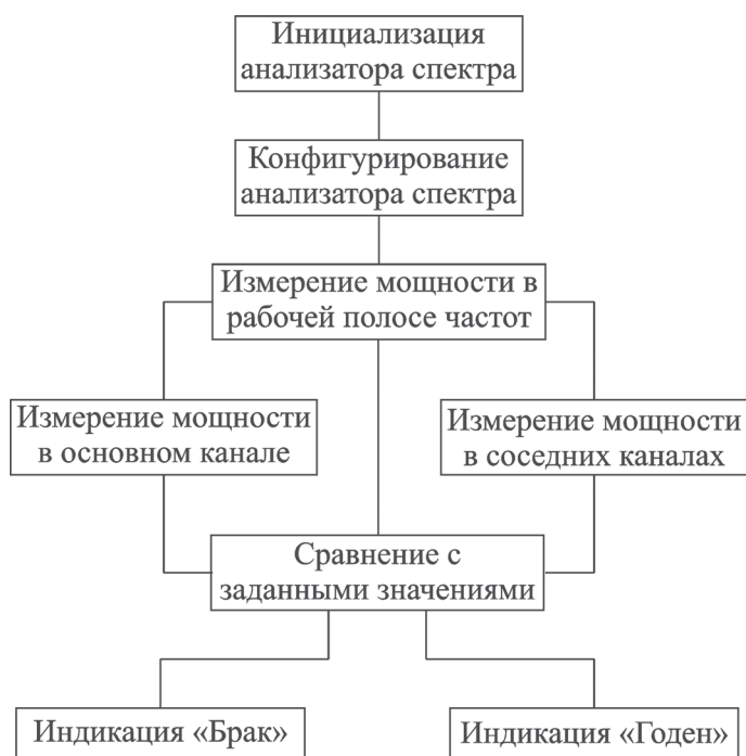
Рис. 3. Структурная схема программы двухстороннего контроля параметров радиоканала
