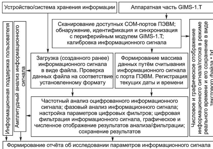
Рис. 2. Функциональная схема программно-инструментального комплекса: ПЭВМ — персональная электронно-вычислительная машина; ГИМС — геоинформационная магнитометрическая система
