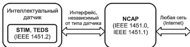
Рис. 2. Включение интеллектуального датчика в сеть согласно [2]
