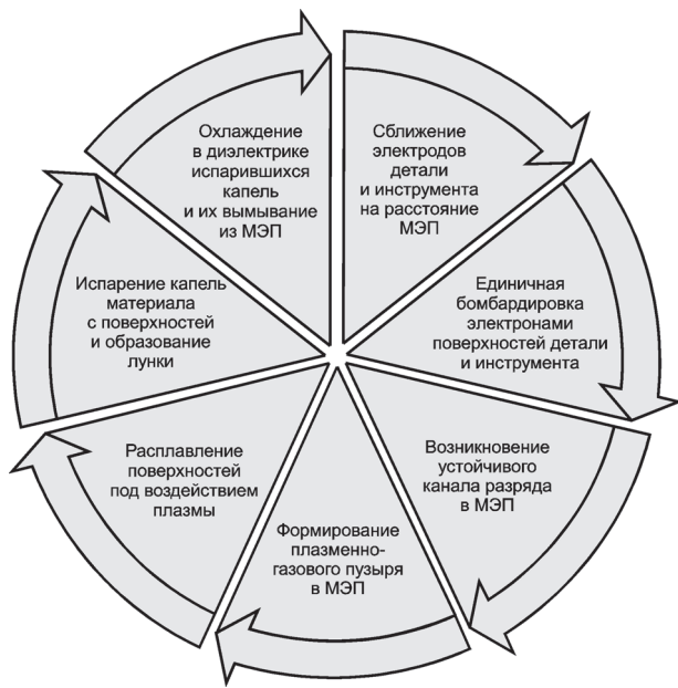
Рис. 2. Иллюстрация физических явлений, сопровождающих технологический процесс электроэрозионного разрушения — удаления металла с поверхности детали тепловым воздействием: МЭП — межэлектродный промежуток
