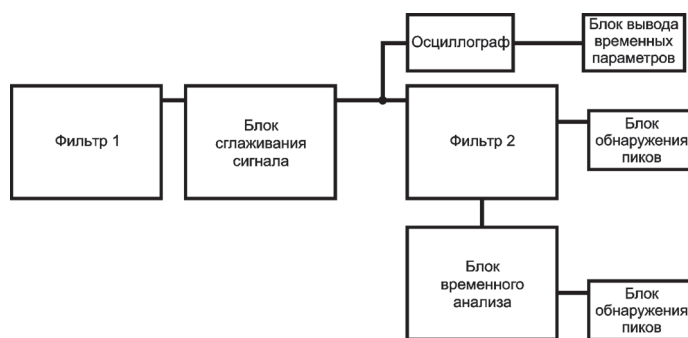
Рис. 1. Схема фильтрации сигнала в виртуальном приборе
