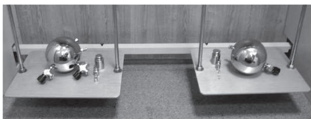
Рис. 2. Уравновешивание пикнометра и эталонного набора гирь на весах-компараторе Raymor HCE-25G
