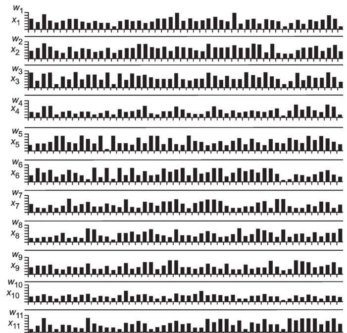
Диаграмма распределения весовых коэффициентов каждого из параметров x_i для каждого j -го обучения (метод градиентного спуска) искусственной нейронной сети ( j = 1, \dots, 50 )
