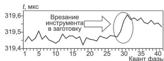
Рис. 2. График изменения среднего значения интервалов времени за пять оборотов шпинделя станка
